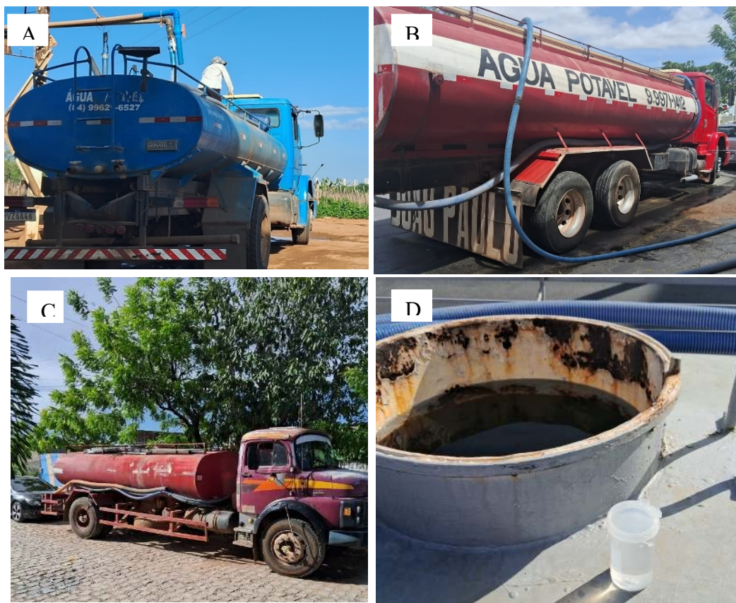
Figura 01 – (A) Carro-pipa abastecendo no poço; (B) carro-pipa entregando água ao fornecedor, (C) carro-pipa pronto para coleta de água para análise físico-química e microbiológica e (D) frasco com amostra de água coletado diretamente no carro-pipa após abastecimento.
