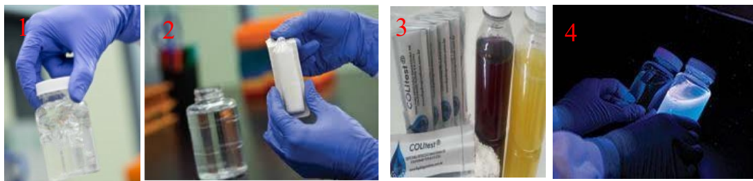
Figura 06 – Ilustração de forma de uso do Colitest para a análise microbiológica de coliformes totais e Escherichia coli para água potável. Fonte: COSTA, (2023).
